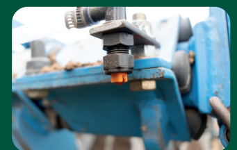
› Sprühleiste mit handelsüblicher Düse an Bestandsmaschine
