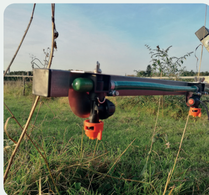
› Handelsübliche Düsen lassen sich für die EM-Ausbringung nutzen
